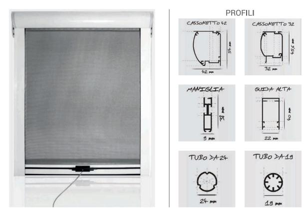
Zanzariera ad avvolgimento verticale a molla con rete senza bottoncini laterali e guide con spazzolino, ideale per fi nestre, portefinestre e finestroni di grandi altezze, disponibile con cassonetto da 32 mm e 42 mm con rete in fibra di colore grigio. Possibilità di realizzazione anche con tessuti oscuranti o filtranti. Aggancio di chiusura con cricchetto, con possibilità di bloccaggio a livelli intermedi.
