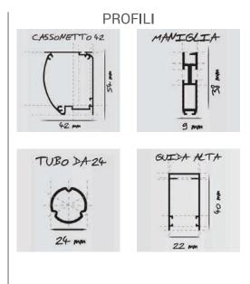
Zanzariera ad avvolgimento verticale a molla con rete senza bottoncini laterali, guide con spazzolino e testata ad espansione per montaggio senza forare il muro.
