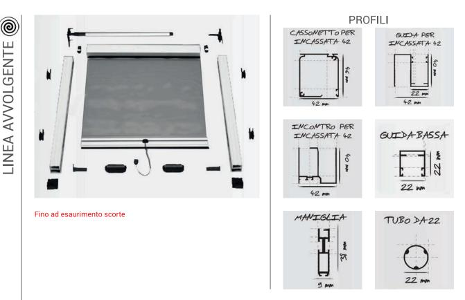
Zanzariera ad incasso ed a scomparsa facile e veloce da montare grazie agli appositi attacchi, realizzabile con avvolgimento verticale e laterale a molla, con rete grigia senza bottoncini e guide con spazzolino, ideale per finestre e portefinestre.
