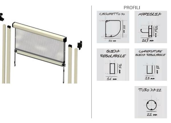
Zanzariera ad avvolgimento verticale con comando a catena posta sul lato del cassonetto, con rete saldata con bottoncini laterali, ideale per finestre e portefinestre, disponibile solo con cassonetto da 50 mm con rete in fibra di colore grigio.
