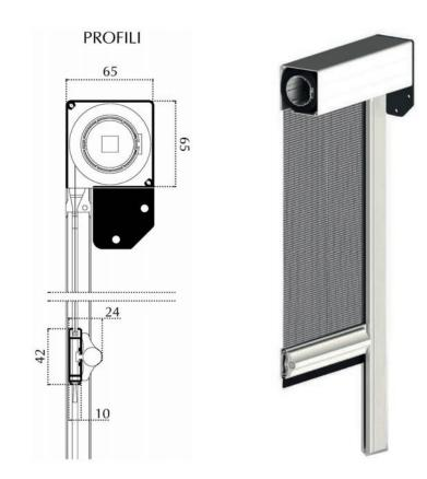
Zanzariera oscurante filtrante avvolgibile verticale per finestra e porta, movimento motorizzato o con comando ad argano.
