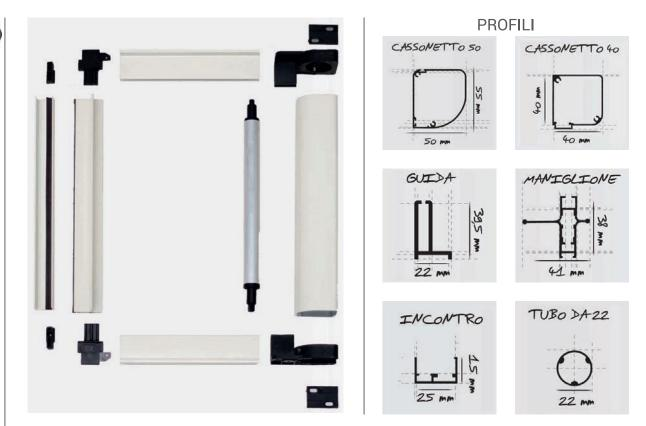
Zanzariera ad avvolgimento laterale a molla e chiusura magnetica con rete saldata con bottoncini, ideale per portefinestre, disponibile con cassonetto da 40 mm e 50 mm con rete in fibra di colore grigio. Possibilità di realizzazione anche con tessuti oscuranti o filtranti.
