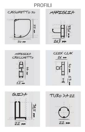
Zanzariera ad avvolgimento verticale a molla con rete saldata con bottoncini laterali, ideale per finestre e portefinestre, disponibile con cassonetto 50 mm con retre in fibra di colore grigio. Possibilità di realizzazione anche con tessuti oscuranti o filtanti.
