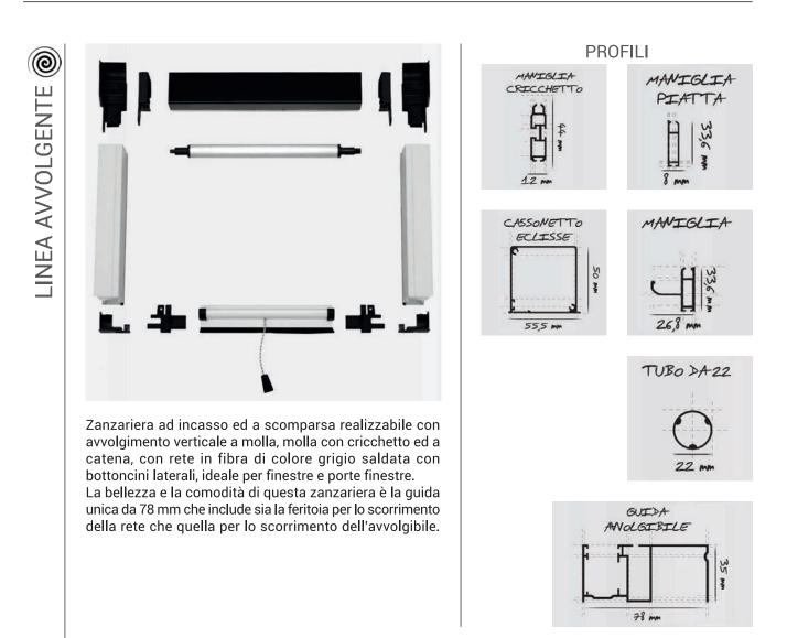
MISURA FINITA: la zanzariera verrà fornita con le stesse misure ordinate. MISURA LUCE (specificare in fase di ordine): la zanzariera verrà realizzata +7 cm in larghezza e +5 cm in altezza.
