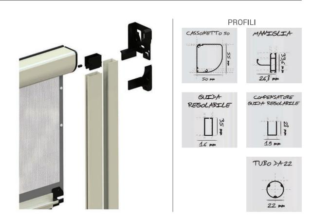
Zanzariera ad avvolgimento verticale a molla con rete saldata con bottoncini laterali. Di serie guide laterali regolabili e freno a molla, disponibile solo con cassonetto 50 evolution. Ideale per installazione con presenza di fuorisquadro.
